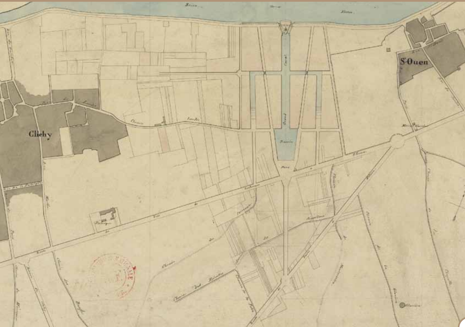
Projet de port et de gare d'eau à Saint-Ouen, dressé par le géomètre Mongelard en 1827. Seul le bassin central sera construit. L'avenue de la Gare (avenue du Capitaine-Glarnier) sera ouverte mais les autres voies (en pointillé) quadrillant le quartier ne verront pas le jour.
